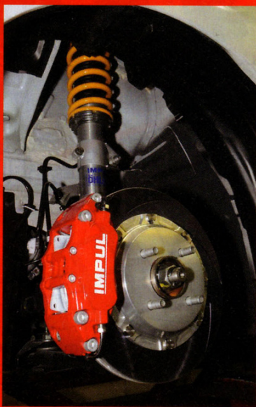
ブレーキは6ポッドタイプで、ローターも専用品を使う。ショックはインパルオーリンズを採用
