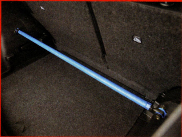
インパルノートでは装着されないトランク内のブレスバー。このほかにリアバンパーの中や前後のフロアアンダーにもブレスバーが追加装着されている
