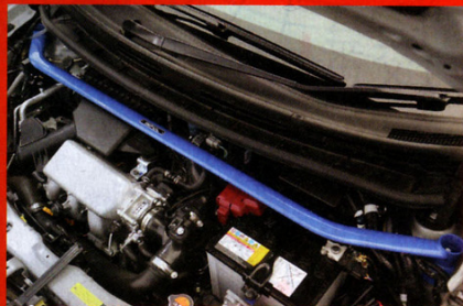
ストラットタワーバーが装着されるエンジンルーム。スロットバルブもチューニングタイプに変更されている
