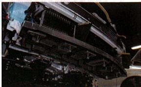
▲インパルバンパーは下部がフロア側に回り込んだ形状なので、アンダーカバーをそれに合わせて丁寧にカット。ノーマルの穴を活かして固定
