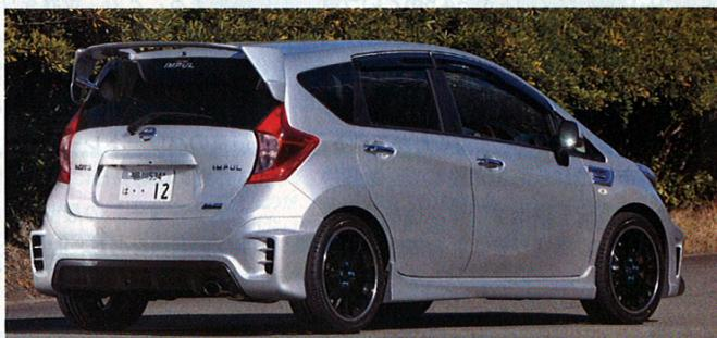
▲イメージを一変させる「エアロダイナミクスシステム」は、フロントバンパースポイラー、フロントグリル、サイドステップ、リアハーフスポイラー、リアウイングの5点キット(24万1500円)。それぞれ単品でも購入も可能だ。さらにオプションとしてエアロサイドバイザー、スポーツダクト、イルミネーションエンブレムが用意されている。
